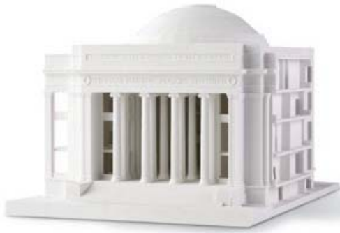
Figuur 7 Selective Laser Sintering model van MIT gebouw
