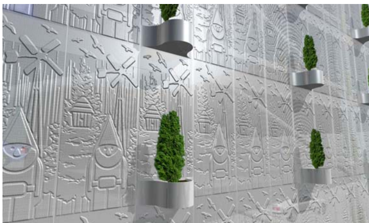
Render van gevelpanelen voor een parkeergarage in Almere-Buiten. De garage is ontworpen door MEI Architecten en Stedebouwers. Paneel van geperforeerd RVS met de afmetingen 2,8 x 1,2 m.
